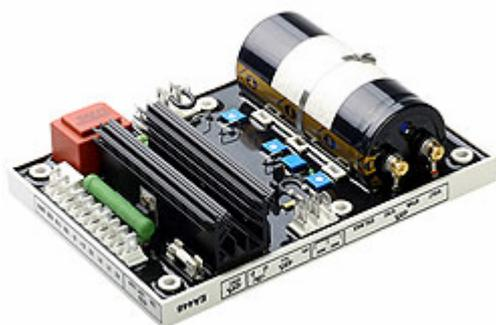
Предназначен для установки на синхронные генераторы **серии LSA** производства **Leroy Somer** взамен AVR R438 и R448. Регуляторами напряжения **EA448 (R438 и R448)** AVR комплектуются генераторы с системой возбуждения AREP, которая обеспечивает возможность работы при коротком замыкании с перегрузкой по току 3 In в течение 10 с.
